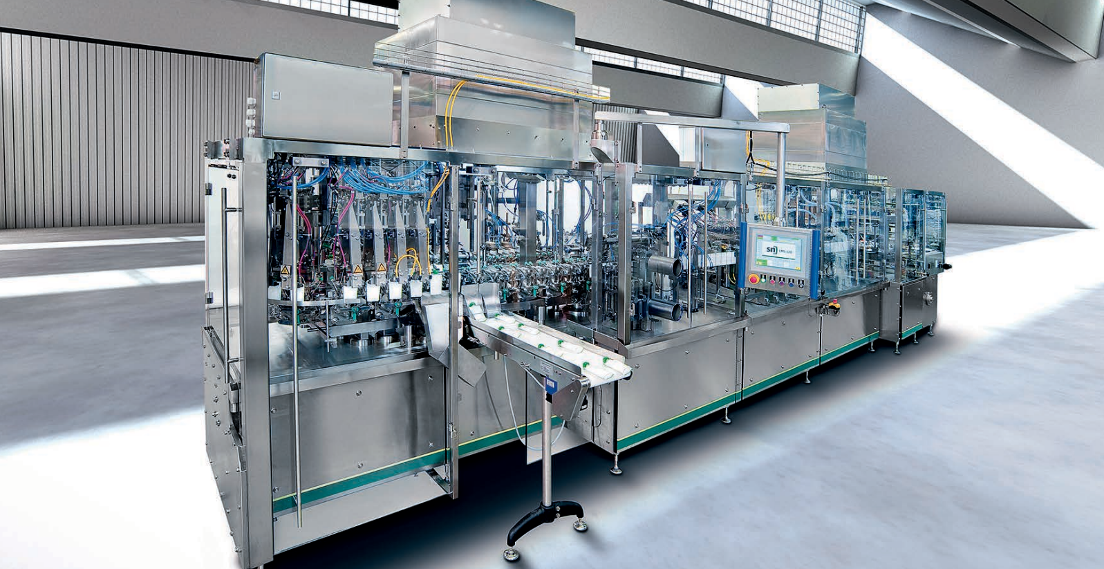
Het grote nieuws van SN op interpack was de vorm-, vul- en sluitmachine LMS 124 voor het maken van stand-up pouches, zoals dit soort yoghurt-verpakkingen.
