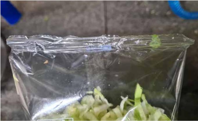
De QipScan meet iedere afwijking in de seal, zoals product dat tussen de seal zit of een seal die niet goed is verwarmd.
