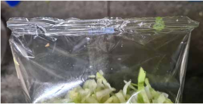
De QipScan meet iedere afwijking in de seal, zoals product dat tussen de seal zit of een seal die niet goed is verwarmd.
